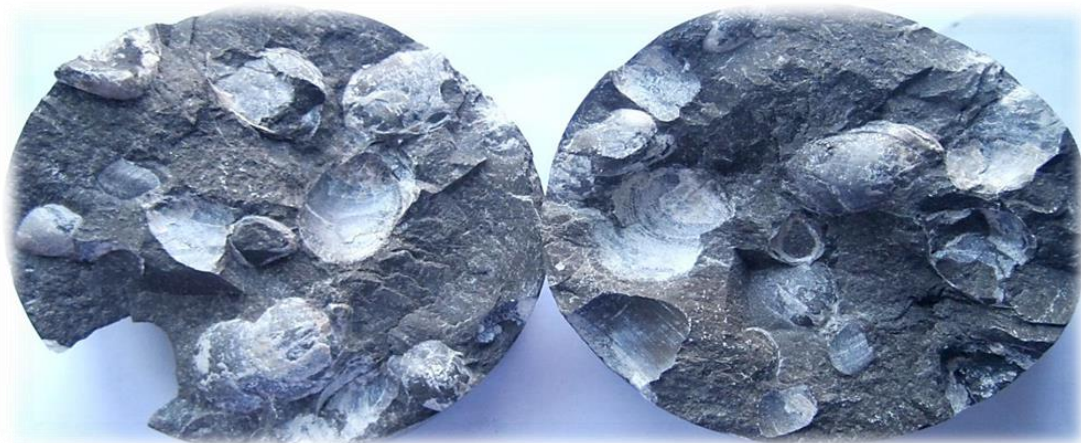
Рис.1. Скв.Гумбулак-56. Инт.отбора образца 2544-2544,2 м, обр. 39. XVa-горизонт. Известняк органогенно-обломочный с многочисленным включением раковин двустворок, принадлежащих к Plagiostoma highworthensis Arkell, средне-верхнеоксфордского возраста.
